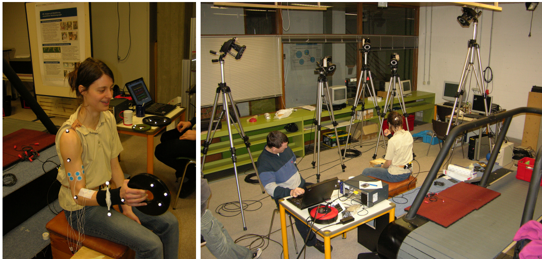
Abb. 3.76: Meßaufbau im Biomechaniklabor Karlsruhe; Proband bewegt Masse nach oben; Elektroden messen EMGs; Marker werden von Kamerasystem aufgenommen.
